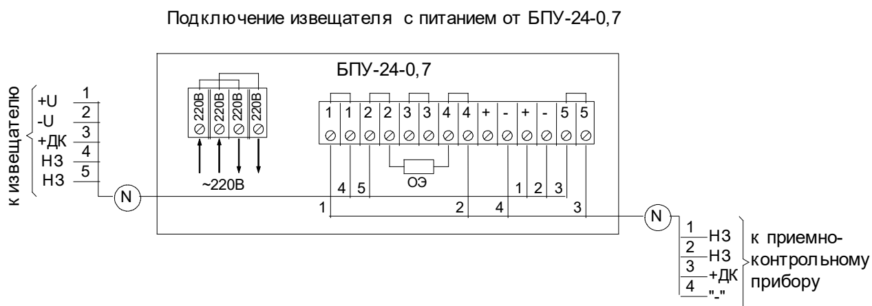
Рисунок 2.12 – Схема подключения извещателя к блоку питания «БПУ-24-0,7»
